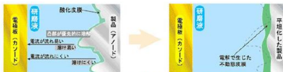
電解研磨前後の表面の様子(模式図)
