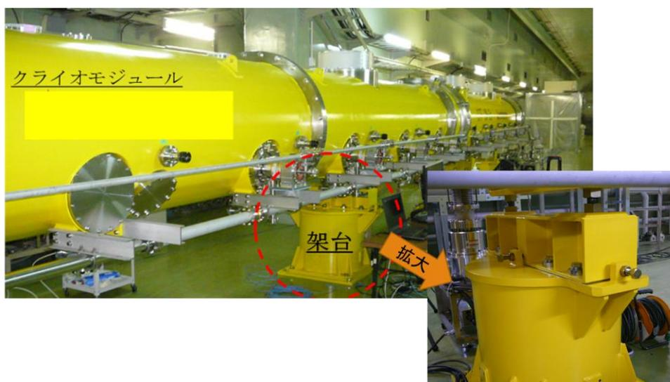
高エネルギー研究機構(KEK)で試作されているクライオモジュールとその架台。
