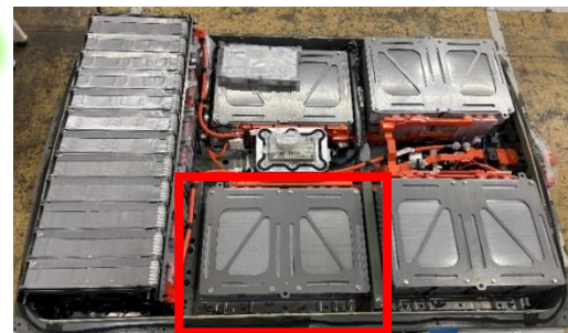
カバーを外したバッテリーパック
